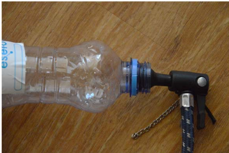
Obr. 1: Bezdušový ventilék TR415 v hrdle PET-lahve.
